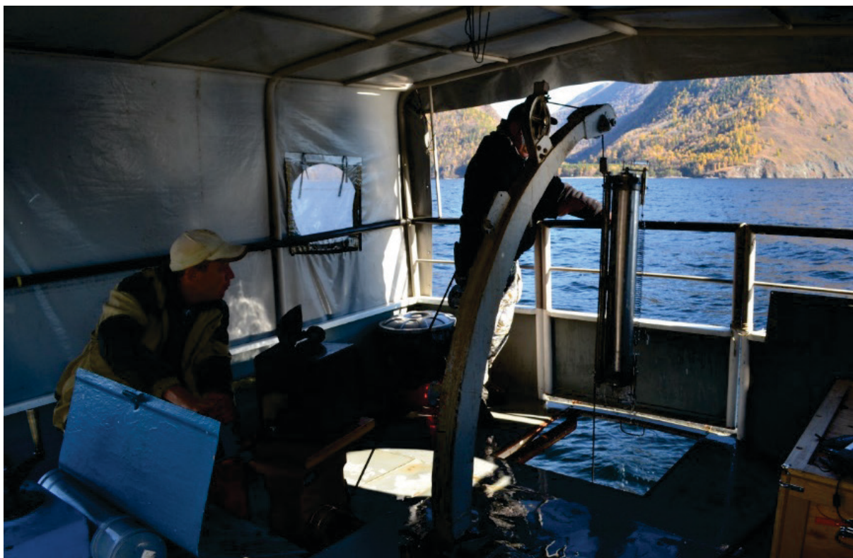
Фото 2. Отбор проб воды батометром с борта судна
